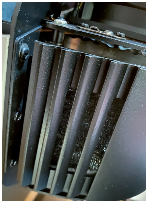
Lüfterloser Betrieb Kühlrippen an den Seiten des Leuchtmittels unterstützen das Temperaturmanagement im Modus „Fan-Off“ (Bild: Torben Lehmann)
