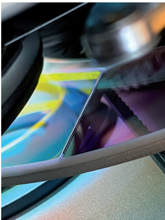
Halbfarben möglich Die Farben des festen Farbrads sind nur durch minimale Stege voneinander getrennt (Bild: Torben Lehmann)
